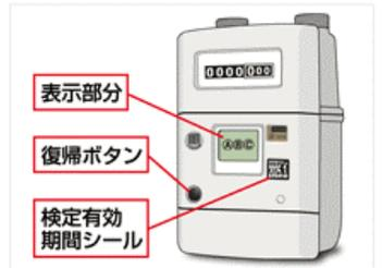
ご家庭のガスメーターは、ガスの使用量を計る機能だけでなく、ガスの使用状況を常に監視し、異常と判断したときはガスを遮断したり、遮断理由などを表示する機能もあります。
