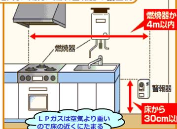
またLPガスは空気よりも重いので漏れた際には床面を這うように広がります。そのため、床面より30cm以内の高さに取り付け、ガス機器から4m以内に取り付けます。
