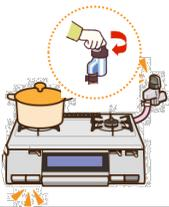
ガス栓を閉めるときは、つまみを横に回すと閉まります。器具栓はガス機器によって形状が異なります。
